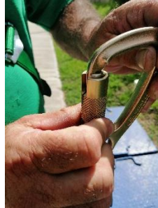
2. Girar la parte móvil hasta que la ranura se alinee con la parte fija del gancho
