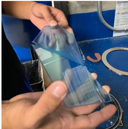
Paso 6. Colocar la lámina centrada en el holter (**porta láminas**), que coincidan las perforaciones del holter con los pines de la base.
