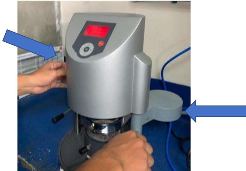
**Una vez terminado el tiempo (los 4 segundos)** inicia el enfriamiento, debe estar pendiente del tiempo indicado en la parte inferior de la pantalla, cuando llegue a cero (el conteo es regresivo), vuelva a presionar el botón gris del lado izquierdo para que suba el pistón.
