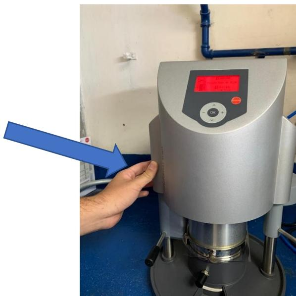
Luego de la descarga del aire, se puede retirar la lámina TERMOFORMADA, proceda a jalar la **palanca del lado izquierda**, en este proceso se obtiene el alineador o el retenedor.
