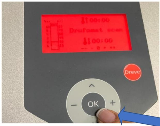
Paso 12. Estar pendiente de la pantalla en la parte superior, indica el tiempo de calentamiento y la presión al **LADO IZQUIERDO** en 6 bars.
