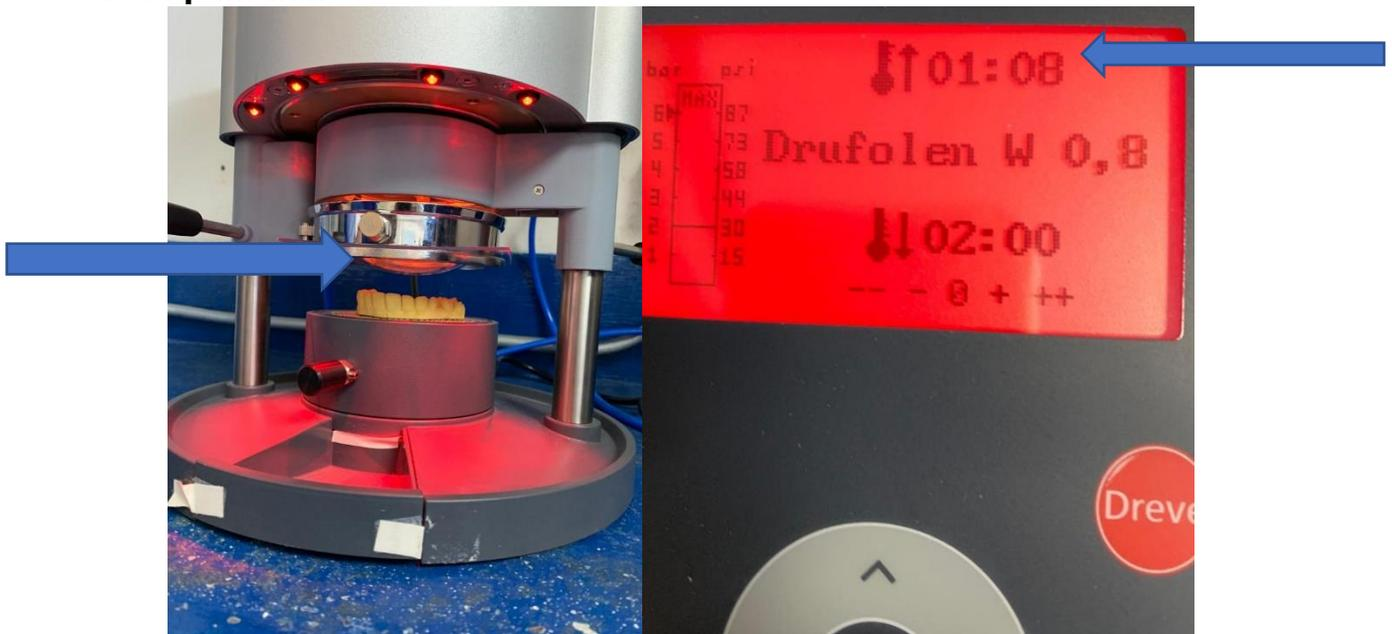
Paso 14. Terminado el tiempo, suena una alarma (pitido) jale la palanca del lado derecho (la resistencia) AL MISMO TIEMPO presione el botón del lado izquierdo color gris, contando 4 segundos (conteo 4,3,2,1) presionando el botón sin quitar el dedo hasta que suene otro pitido.
